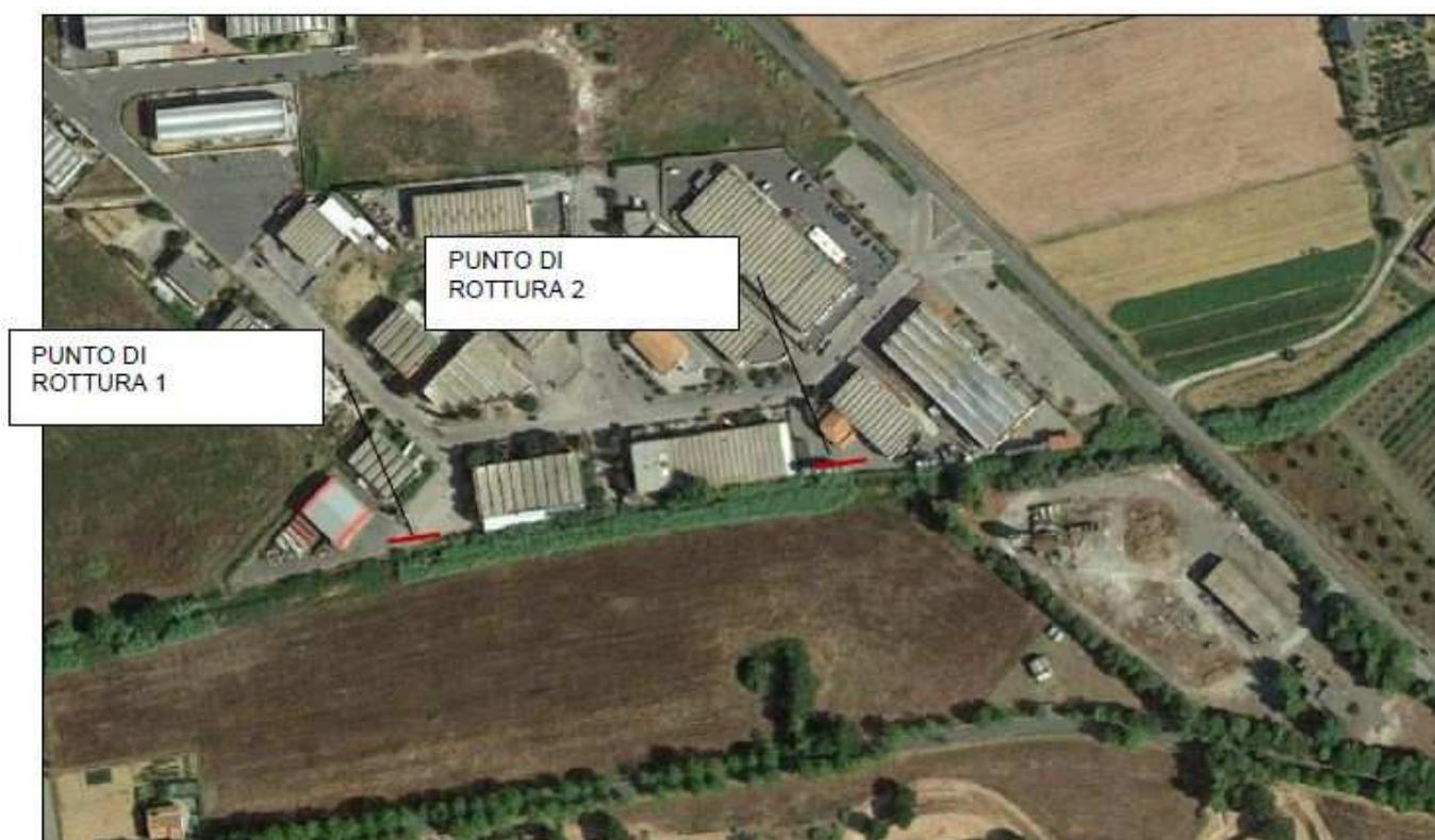
Figura 3.1 -Punti di rottura arginale sul Fosso degli Alberelli da “Relazione idrologica e idraulica” del Terzo Regolamento Urbanistico del Comune di Bibbona
